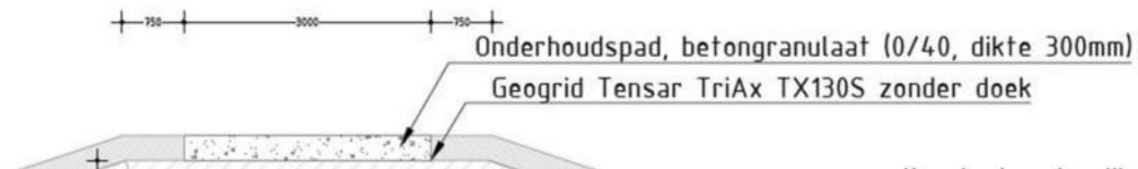
Figuur 7: materialisatie-eisen WL voor onderhoudspad
