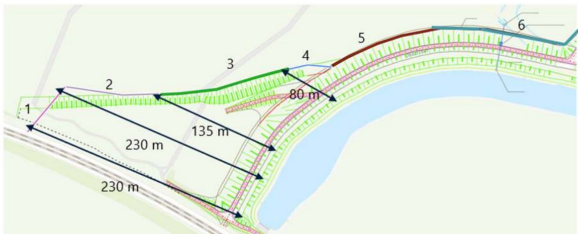
Figuur 5: pipingmaatregelen dijkvak 6.
