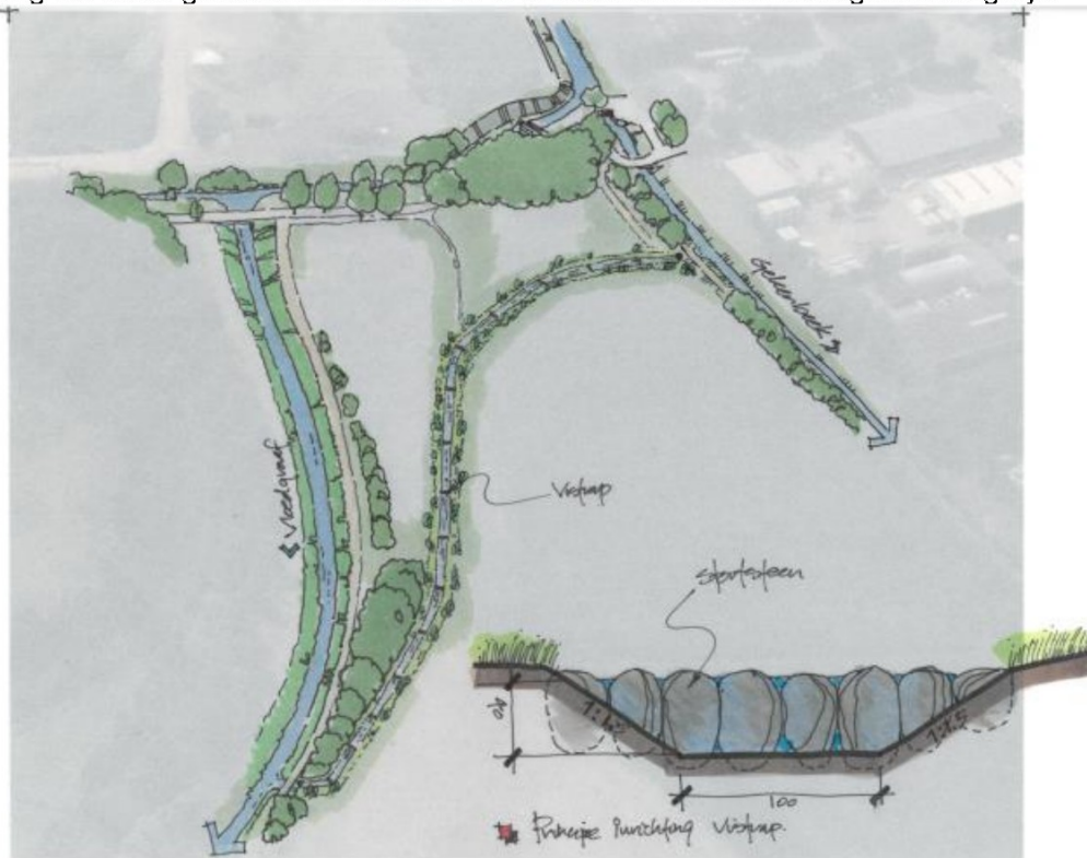
Figuur 41: impressie ontwerp vistrap stuw Millen
