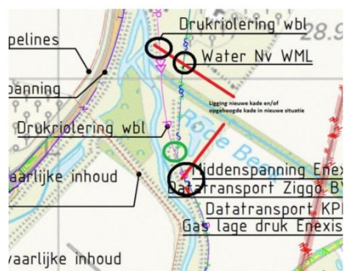
Figuur 37: kabels en leidingen Rode Beek benedenstreams
