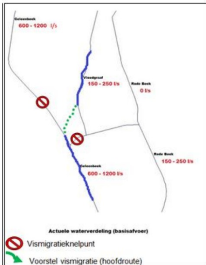
Figuur 3: waterverdeling en vismigratie bij Geleenbeek-Vloedgraaf ter hoogte van stuw Millen
