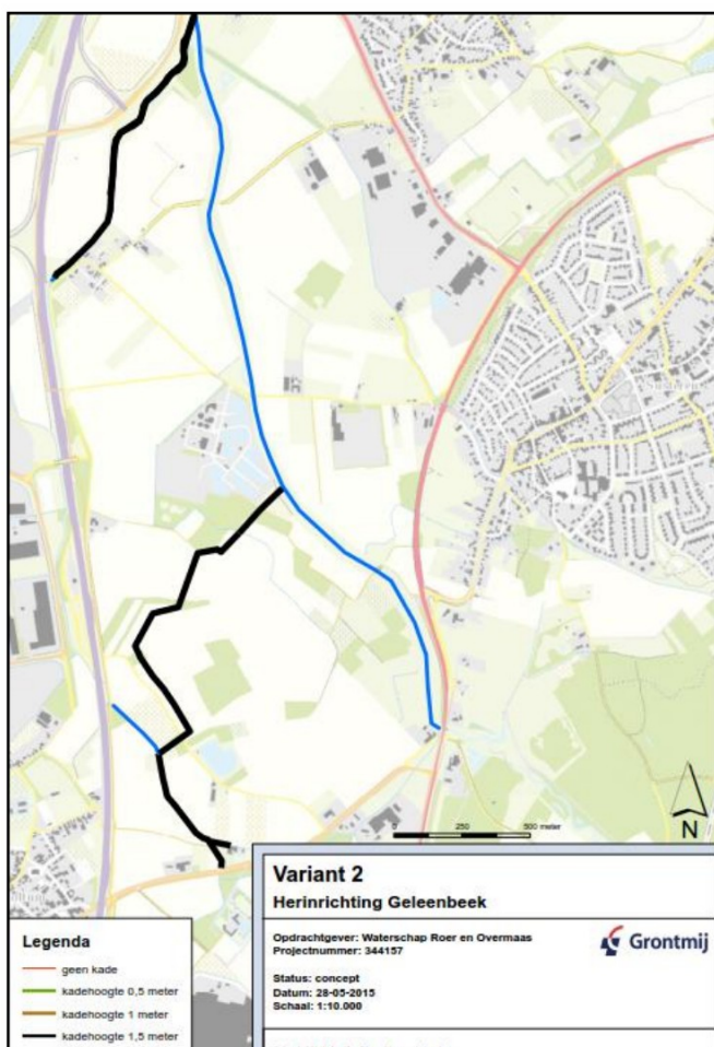
Figuur 18: globaal benodigde kadehoogtes variant 2
