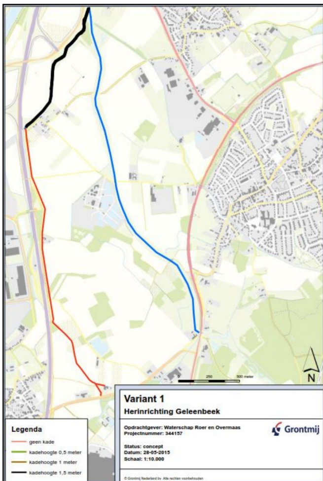
Figuur 17: globaal benodigde kadehoogtes variant 1
