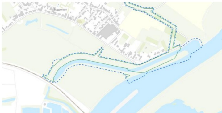
Figuur 7. Ontwerp van de eindsituatie. Groene lijnen geven de contouren weer van de nieuwe dijk. Blauw gestippelde lijnen geven de werkgrens weer (bron: TAUW).
