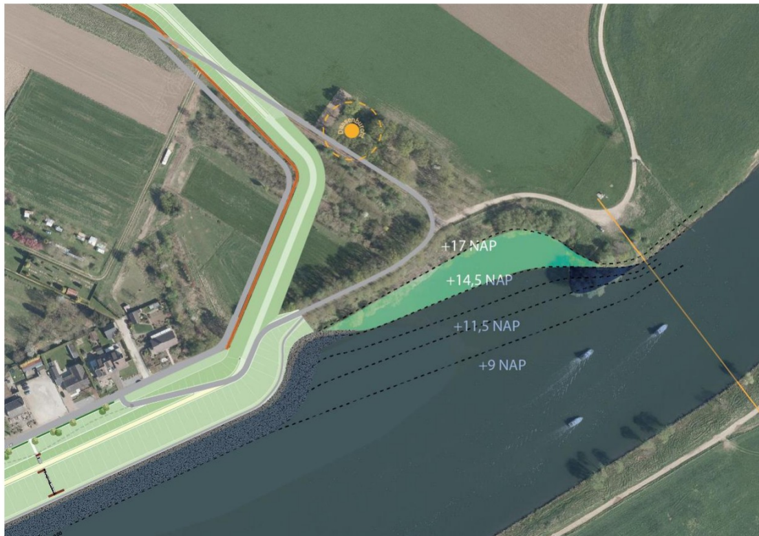
Figuur 5. Schetsontwerp verflauwen oever kom en inrichting rietoever (bron: Dura Vermeer, 2024)
